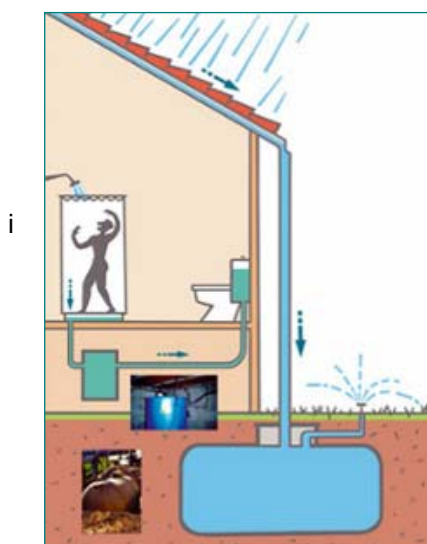
Figura 14: Imatge del sistema de reutilització de les aigües grises Font: ecoaigua.com
