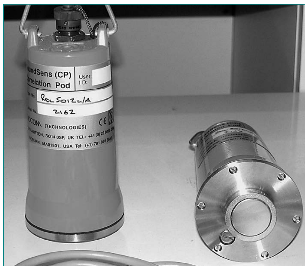
Il·lustració 14: Vistes del sensor de detecció de fuites d'aigua en conduccions en baixa.
