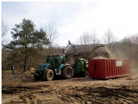
Exemple 3. Aprofitament de biomassa en una aclarida de millora en una fageda. En aquest cas, la biomassa permet aprofitar peus de diàmetre petit i mal conformats que no tenien sortida comercial.
