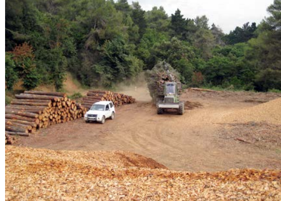
Exemple 2. Aprofitament de biomassa en una tallada selectiva. Si l'aprofitament de biomassa afecta molta quantitat de fusta, s'ha de preparar molt bé la logística, perquè cal un espai obert per classificar la fusta, triturar-la i fer les piles on carregar els camions. També s'ha de classificar la fusta correctament en cas que es puguin aprofitar productes de més valor afegit, com, per exemple, troncs de bona qualitat per a serra.
