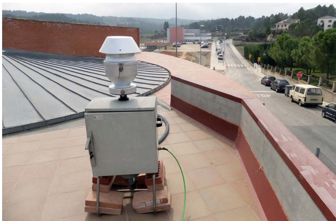
Foto 2: Captador PM10. Sant Salvador de Guardiola (Bages). Estudi específic sobre la qualitat de l'aire. (Foto: Anna Mazas.)
