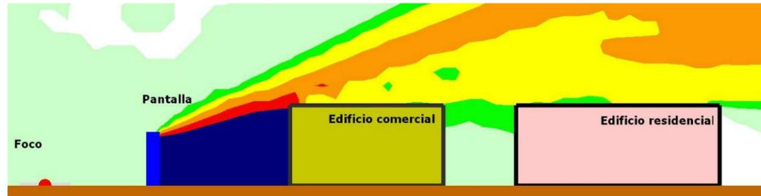
Las situaciones en las que la cota de la carretera difiere con respecto de los edificios objetos de protección la eficacia de la aplicación de la pantalla depende de: la diferencia de cotas, la distancia de los edificios a la vía y la altura de los edificios.
