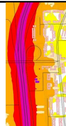
En estos dos ejemplos el desarrollo de las viviendas se efectúan "de espaldas" al foco de ruido potenciando que la mayor cantidad de fachada posible esté sometida a los niveles mas bajos. Esta configuración de los edificios complementada con una localización de los usos sensibles de las viviendas en las fachadas menos expuesta el ruido (fachada tranquila), constituye un ejemplo de diseño urbano de autoprotección frente al ruido.
