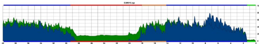
Gràfica de resistògraf (Resi@ PD-500) on s'observen zones en bon estat i zones amb podriment incipient i avançat
