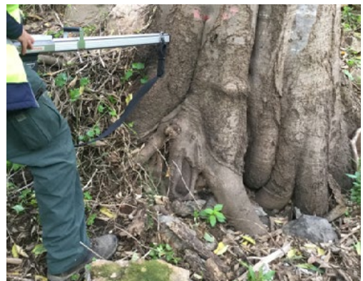
Imatge d'una inspecció amb resistògraf a la base d'un lledoner
