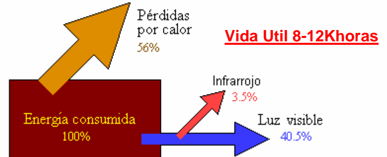
Balance energético de una lámpara de vapor de sodio a alta presión
